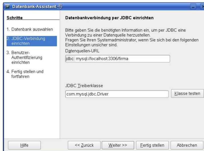
Abbildung 19.52: Einbinden einer MySQL-Datenbank als Datenquelle per JDBC-Treiber
